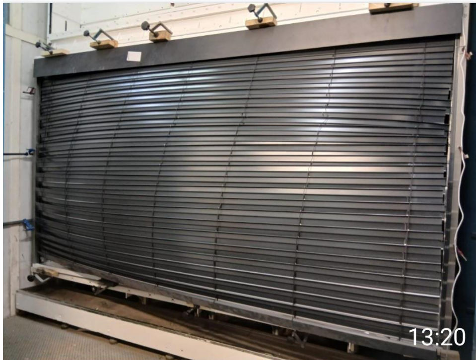
Detalle de la muestra en el límite de presión de ensayo
